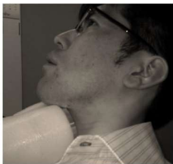
Thyroid measurement with the NaI spectrometer NaIスペクトロメーターによる甲状腺測定
